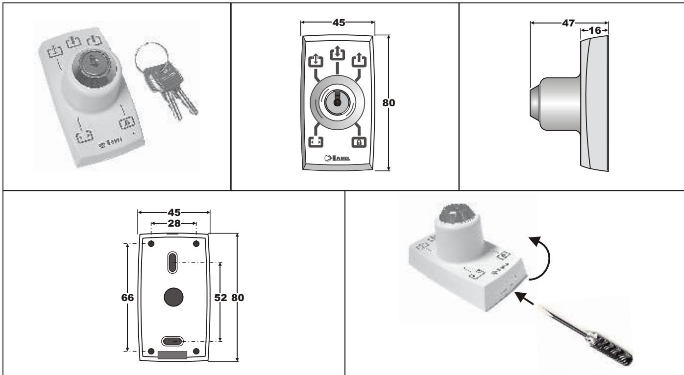
Механический переключатель с ключом **EV-MSEL** позволяет задавать рабочую программу автоматической двери EVOLUS. Для его работы установить на ВКЛ. dip-выключатель 6 на S1 (см. параграф 14).
