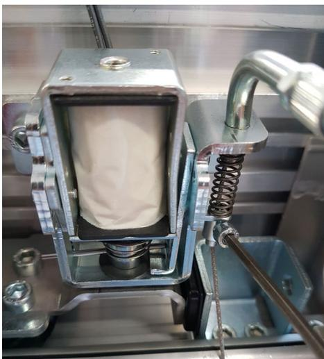
Установите пружину сжатия и вставьте металлический трос внутри соответствующего фиксатора, затем зафиксируйте его с помощью винтового зажима. Отрегулируйте натяжение троса, чтобы обеспечить небольшую предварительную нагрузку пружины.
