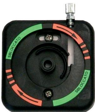
Для фиксации автоматики с правой, или с левой стороны необходимо зафиксировать регулировочную задвижку в нижней части ручки разблокировки.
