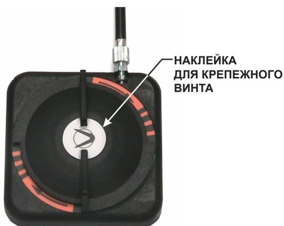
После вставки ручки затяните крепежный винт, вставьте оболочку и переведите ручку в положение NON SBLOCCATA («НЕ РАЗБЛОКИРОВАНА»). В этом положении должна быть видна только оранжевая часть этикетки с обозначенными черными стрелками. Проверьте работоспособность системы, повернув ручку по часовой стрелке и крепко держа кабель рукой.
