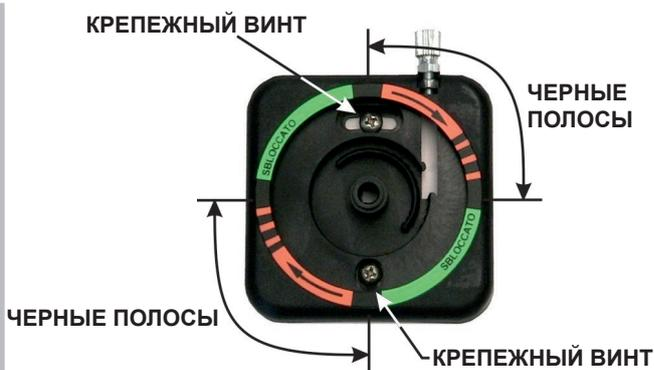
Просверлите стену и закрепите нижнюю часть механизма разблокировки с помощью крепежных винтов. Поместите этикетку, как показано на рисунке, ориентируясь на четыре черные полосы на этикетке, которые следует расположить в 4 главных точках. Вставьте регулирующую задвижку с двумя гайками: одну вставьте в специальную пластиковую прорезь, а другую — снаружи.
