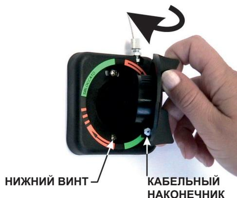
Вставьте ручку разблокировки в днище механизма, следя за тем, чтобы наконечник троса в гнезде блока троса и ручка находились в правильном положении: при установленной ручке наконечник троса должен находиться в положении чуть дальше по часовой стрелке от нижнего крепежного винта.
