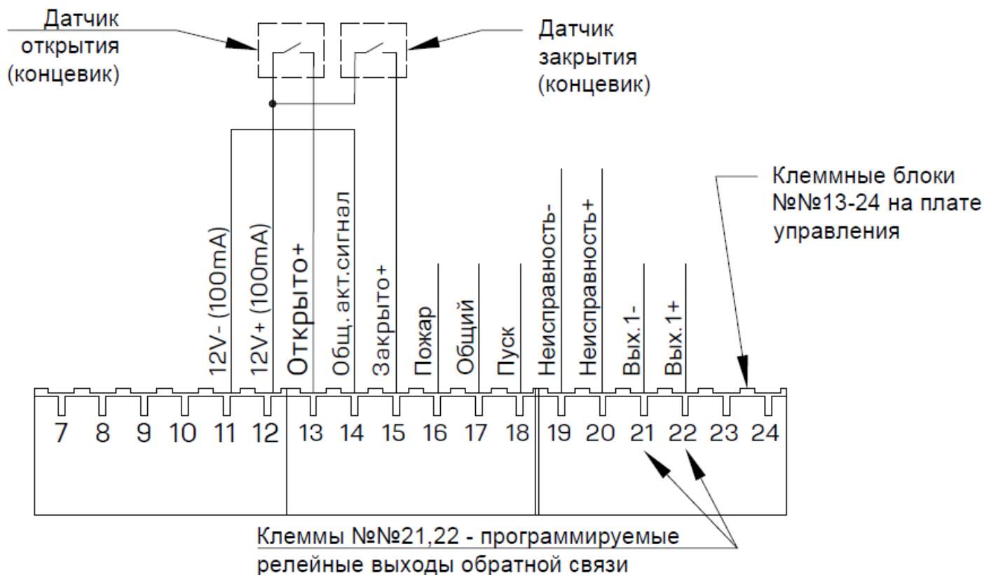
Рис. 6. Схема подключения выходов обратной связи на пульт диспетчеризации.
