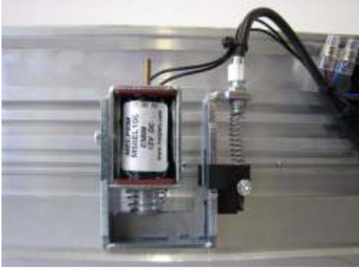
Posizionare la molla a compressione e inserire il cavo metallico all'interno dell'apposita ancora di sblocco, quindi bloccarlo con il morsetto a vite.
