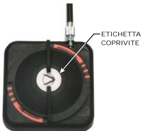
Una volta inserita la manopola fissare la vite di chiusura, inserire la guaina e portare la manopola in posizione NON SBLOCCATA. In questa posizione si devono vedere solo la parte arancione dell'etichetta con disegnate le frecce nere. Provare il buon funzionamento del sistema ruotando la manopola in senso orario e tenendo il cavo teso con la mano.
