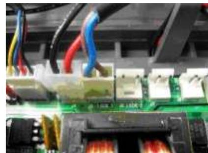
Nel kit elettroblocco viene fornito il cavo di alimentazione, il quale da un lato si presenta con i due conduttori che andranno collegati ai fili di uscita del solenoide dell'elettroblocco mediante gli appositi morsetti, dall'altro termina con una connessione che andrà inserita nel connettore LOCK1 a bordo della centralina elettronica dell'operatore Evolus.
