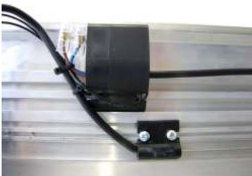
Posizionare il secondo componente di sblocco a circa 300mm dal centro dell'elettroblocco e fissarlo con due viti autofilettanti fornite nel Kit.
