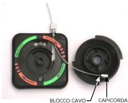
Fare passare il cavo di sblocco nella feritoia del fondo e quindi dentro al registro di regolazione come in figura, dopodiché posizionare il capocorda del cavo stesso sul blocco cavo della manopola di sblocco (vedere figura).
