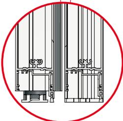
Distanza tra vetro e profilo < 8 mm per sovrapposizione montanti. Profilo a labirinto per doppia tenuta all'aria + spazzolino con funzione antigraffio in caso di sfondamento. Guarnizione complanare copriviti.
