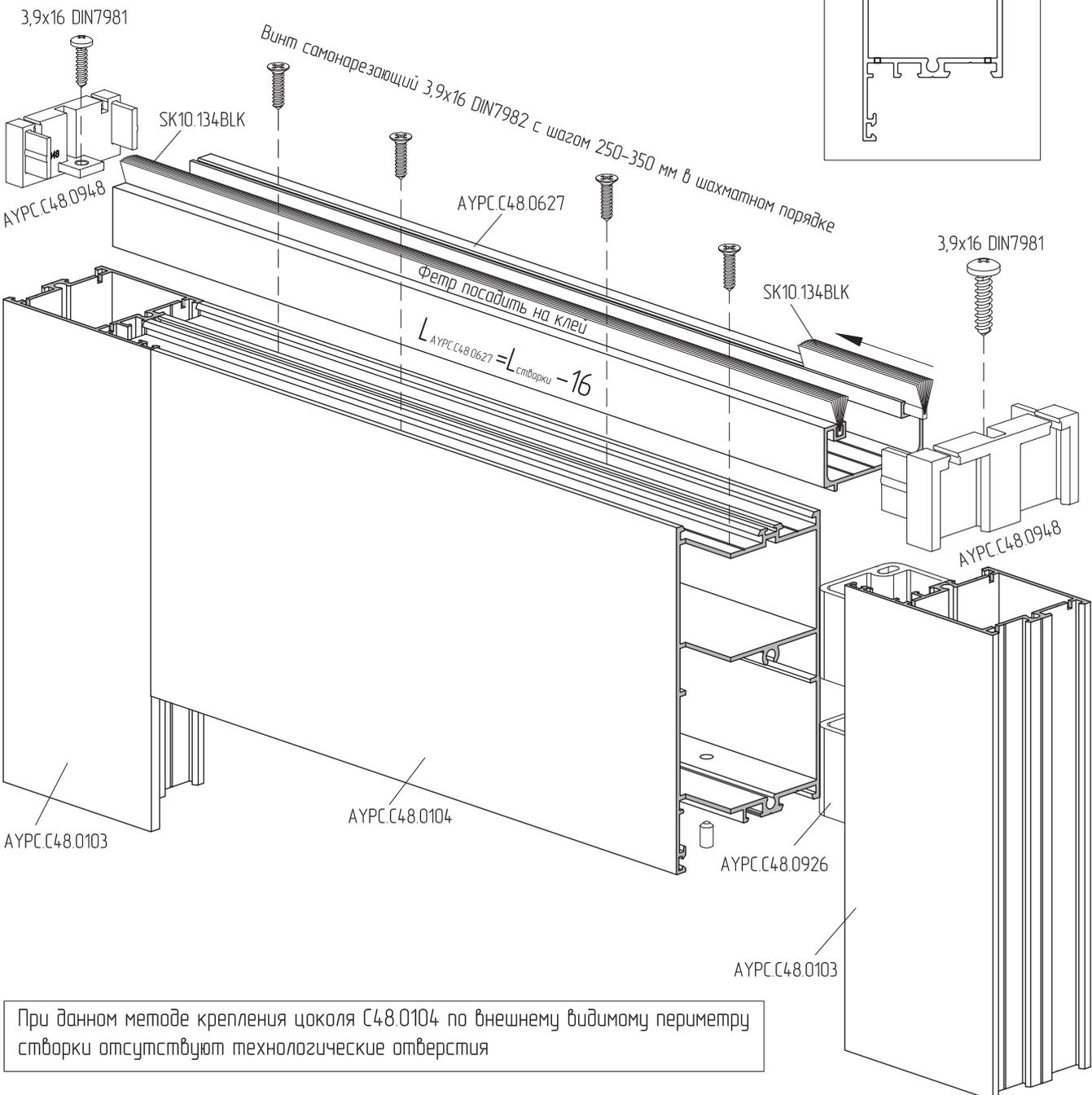
При данном методе крепления цоколя С48.0104 по внешнему видимому периметру створки отсутствуют технологические отверстия
