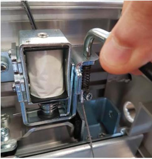
Проверьте работу механизма ручной разблокировки: когда ручка находится в заблокированном положении, электрозамок должен работать нормально.
