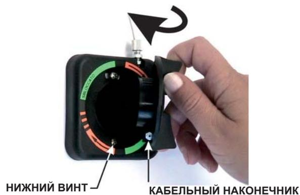
Вставьте ручку разблокировки в днище механизма, следя за тем, чтобы наконечник троса в гнезде блока троса и ручка находились в правильном положении: при установленной ручке наконечник троса должен находиться в положении чуть дальше по часовой стрелке от нижнего крепежного винта.
