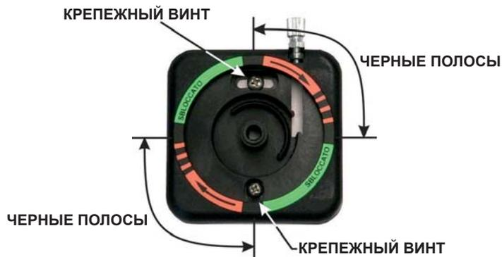
Просверлите стену и закрепите нижнюю часть механизма разблокировки с помощью крепежных винтов. Поместите этикетку, как показано на рисунке, ориентируясь на четыре черные полосы на этикетке, которые следует расположить в 4 главных точках. Вставьте регулировочную задвижку с двумя гайками: одну вставьте в специальную пластиковую прорезь, а другую — снаружи.
