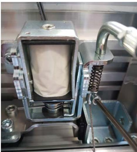
Установите пружину сжатия и вставьте металлический трос внутрь соответствующего фиксатора, затем зафиксируйте его с помощью винтового зажима.
