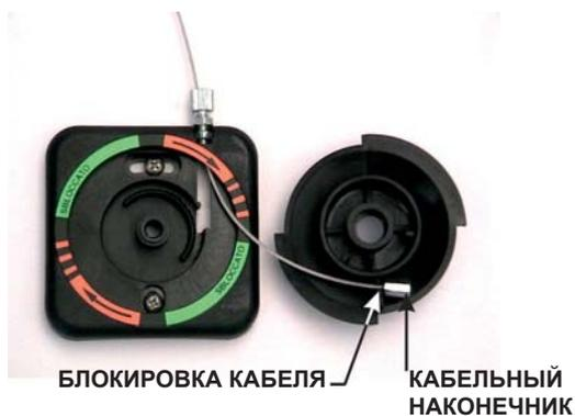
Пропустите трос механизма разблокировки через отверстие в нижней части, а затем в регулировочную задвижку, как показано на рисунке, после чего поместите наконечник троса на фиксатор троса ручки разблокировки (см. Рис.).
