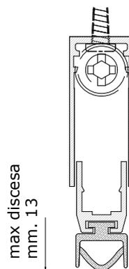
**Функции:** автоматическое закрытие щели между дверью и полом для защиты от сквозняков, проникновения пыли, насекомых, дыма, а также с целью звукоизоляции.
