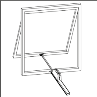
Установка на верхнеподвесном окне
