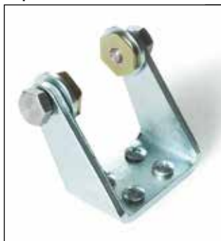
Регулируемый кронштейн из оцинкованной стали (код 40235F) Дает возможность крепления привода по всей его длине. Используется только в конфигурации одиночного привода.
